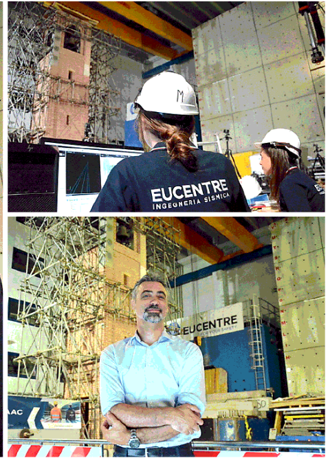
Nella foto grande i ricercatori di Eucentre vicino al campanile in mattoni e malta costruito all'interno del centro di ricerca per testare la tenuta alle scosse sismiche create con strumenti tecnologici all'avanguardia. A destra in alto le due ricercatrici che azionano i computer da cui parte l'input per il simulatore sismico, a destra l'ingegnere Paolo Morandi che lavora alla ricerca di Eucentre (fotoservizio Donato Albanesi)
