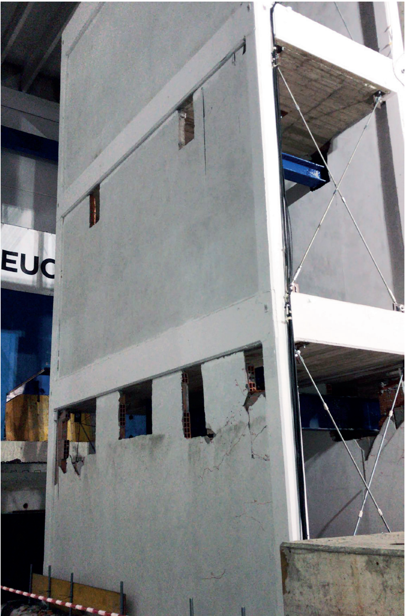
(b) Vista completa dell'edificio privo del sistema I-Pro 1 dopo il sisma 0.44g.
