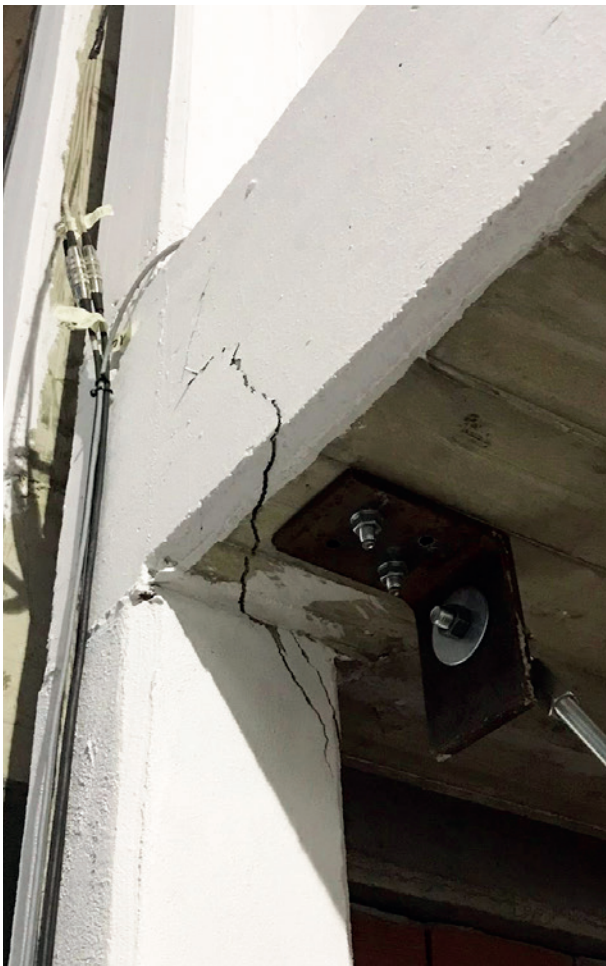
(e) Rottura del nodo trave-solaio posteriore-sinistro dell'edificio privo del sistema I-Pro 1 dopo il sisma 0.44g: (f) Rottura del nodo trave-solaio posteriore-destro dell'edificio privo del sistema I-Pro 1 dopo il sisma 0.44g.
