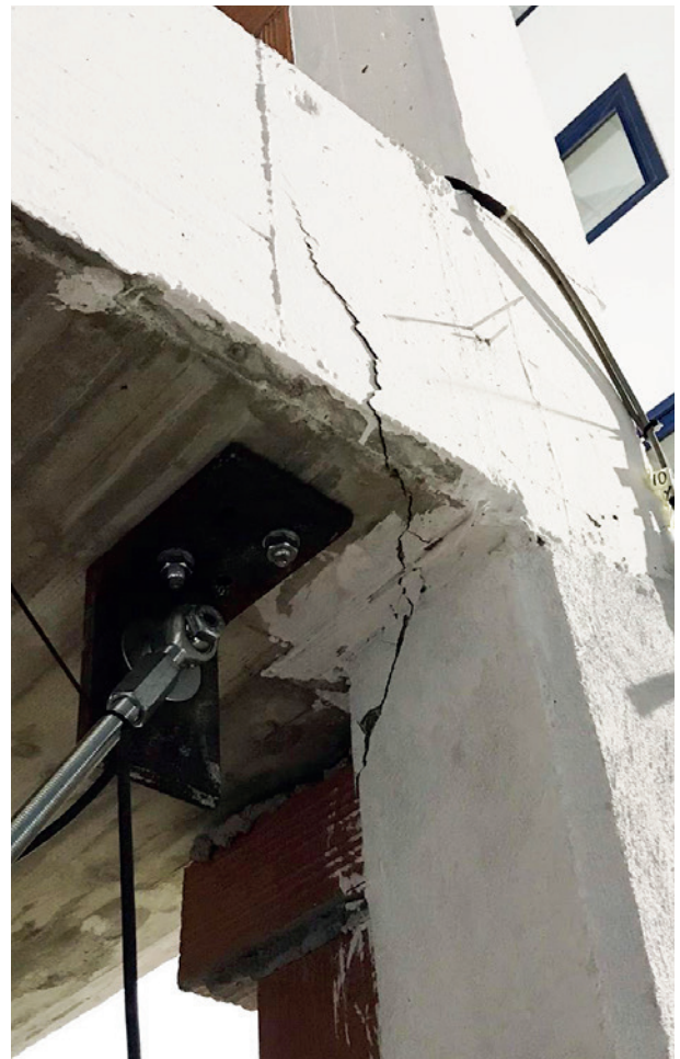
(e) Rottura del nodo trave-solaio posteriore-sinistro dell'edificio privo del sistema I-Pro 1 dopo il sisma 0.44g: (f) Rottura del nodo trave-solaio posteriore-destro dell'edificio privo del sistema I-Pro 1 dopo il sisma 0.44g.
