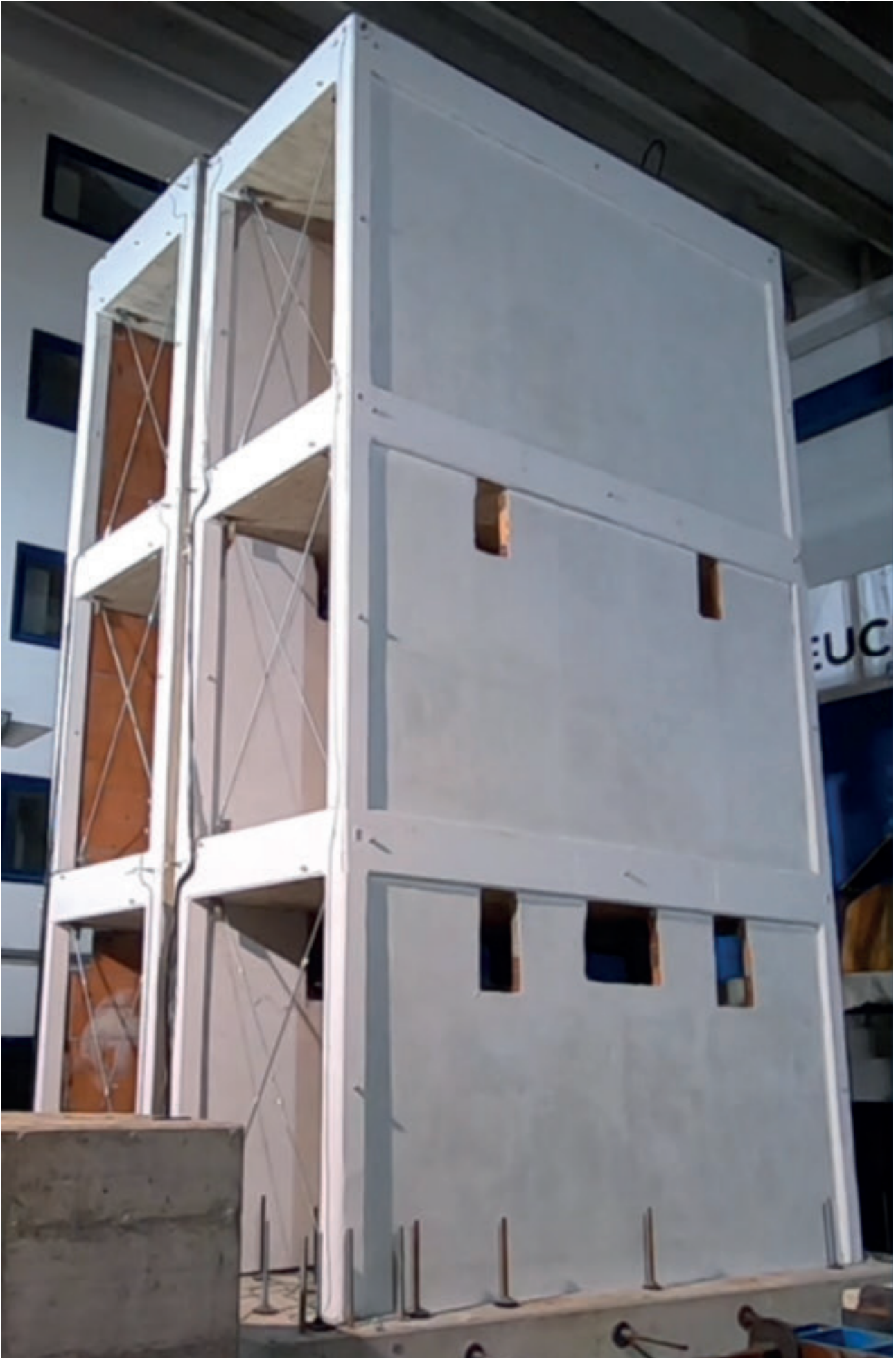
(a) Vista completa dell'edificio con il sistema I-Pro 1 dopo il sisma 0.44g.
